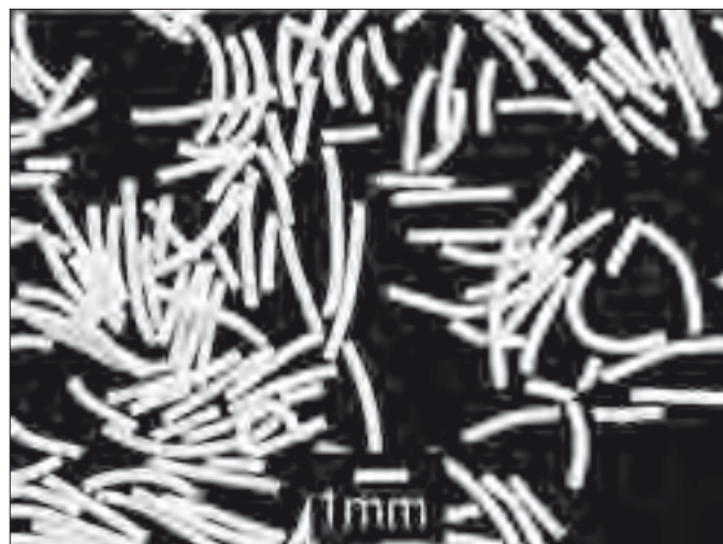
Fig. 5- Fotografía de las fibras obtenidas a partir de la pasta P2 por una boquilla de 300 \mu m después de ser troceadas en seco y tratadas térmicamente.
