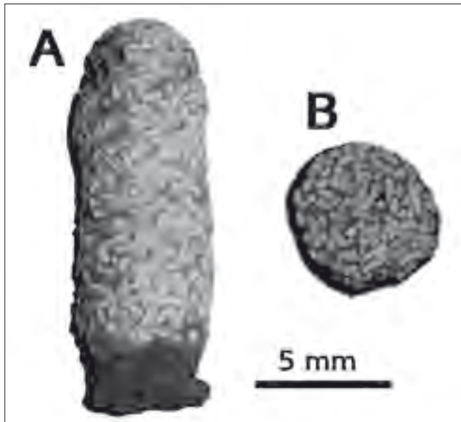
Fig. 7- Composite HA/β-TCP (60%/40%). A) fotografía del composite. B) corte transversal pulido. fibra polvo.
