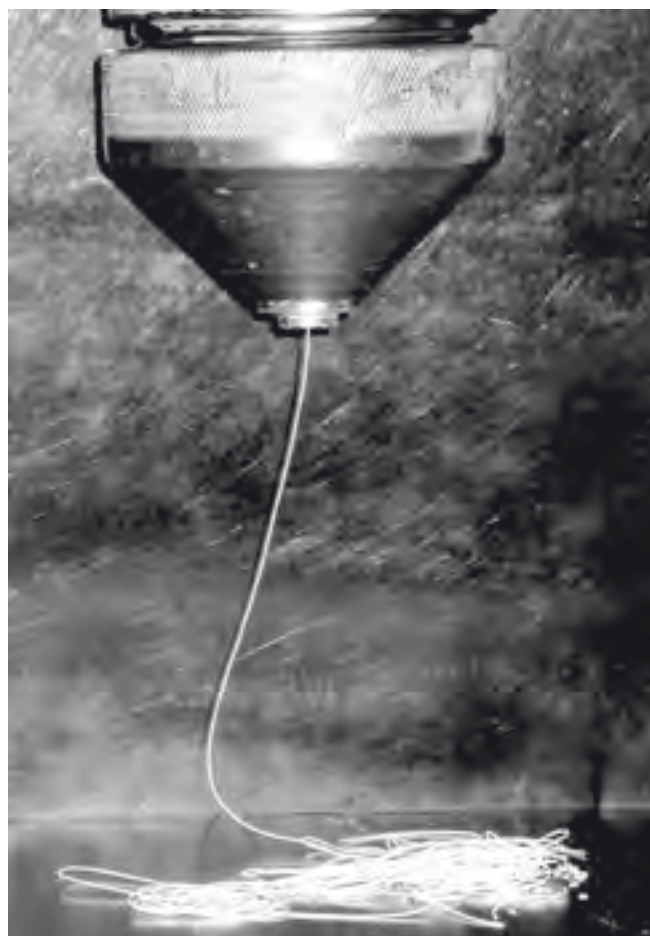
Fig. 2- Extrusión de una fibra continua por una boquilla de 200\mu\text{m} de diámetro.
