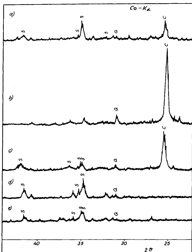
Fig. 7.—Difractogramas de las diatomitas calcinadas a 1.000°C: a) Muestra: CI-A (Area III). b) Muestra: CI-D (Area III). c) Muestra: CI-cE (Area III). d) Muestra: DC-7A (Area II). e) Muestra: V2 (Area II). S: Diópsido \text{CaO} \cdot \text{MgO} \cdot 2\text{SiO}_2 ; Q: Cuarzo; C: Cristobalita.
