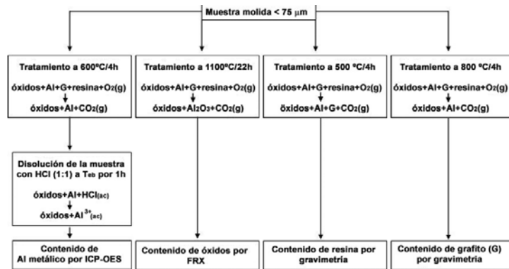
Figura 6. Esquema del método de análisis utilizado.
