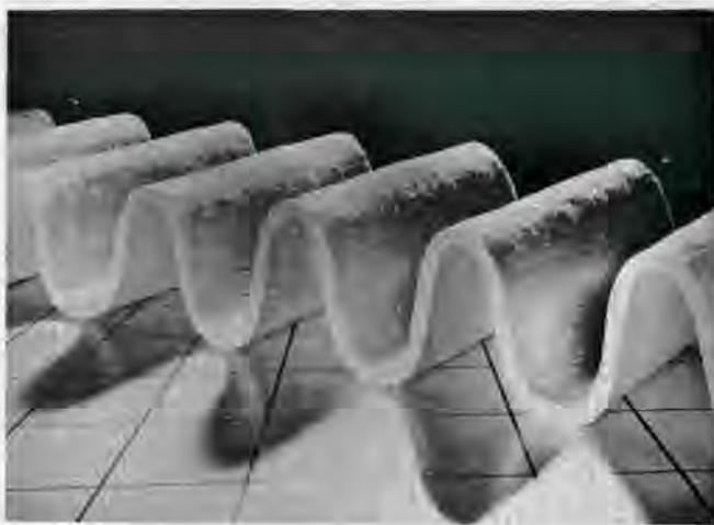
W/m°C a 1400°C con una manta de 128 kg/m<sup>3</sup>). Es químicamente estable, resiste el ataque químico que se produce comúnmente en hornos industriales y soporta el choque térmico. Otras propiedades son su peso ligero, una buena insonorización y alta reflectancia del calor. La alta resistencia se mantiene después de la cocción y, si se humedece con agua o vapor, las propiedades físicas permanecen inalteradas después del secado.
