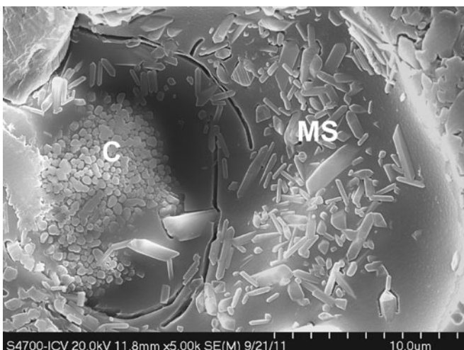
Figura 10. Microfotografía (FE-SEM) de los cristales en forma de prismas de protoenstatita (MS) y de rosetas de \alpha -cristobalita (C) en el interior de un poro.
