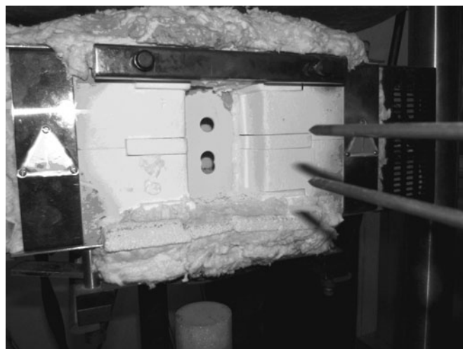
Figura 3. Sistema de atmósfera controlada: vista frontal de la cámara con los orificios para el ingreso del extensómetro.
