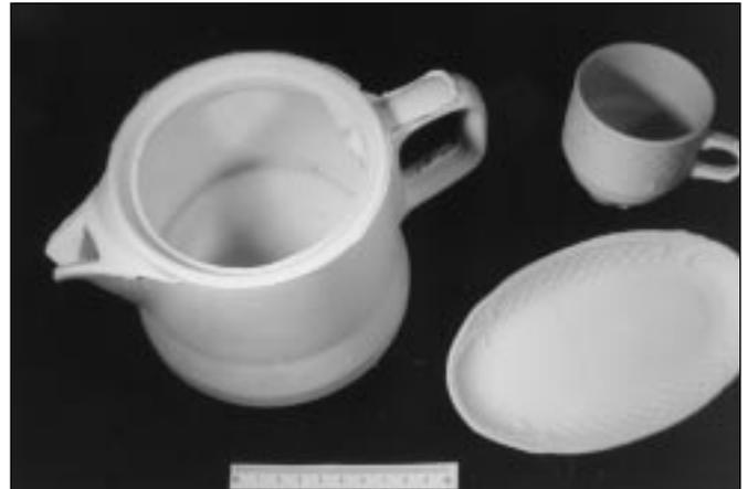
Figura 2 Selección de piezas usadas en los ensayos de secado. Piezas secadas a blanco por microondas correctamente.
