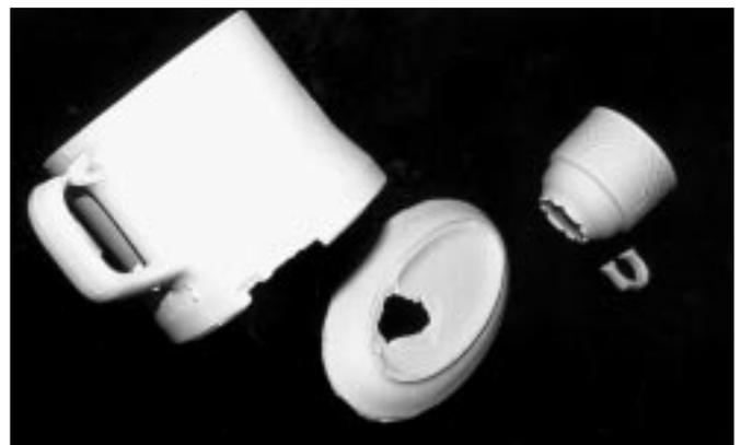
Figura 3 Daño sufrido por las piezas como consecuencia de un secado por microondas excesivamente rápido.
