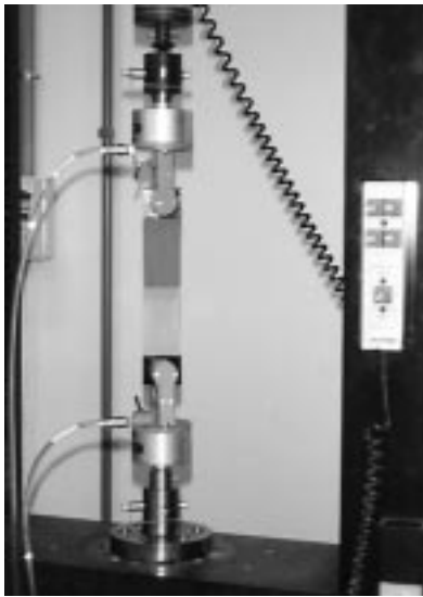
Figura 10- Montaje para la determinación de la adherencia de la emulsión al tejido.
