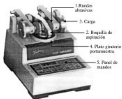
Figura 6. Equipo de medida de la resistencia a la abrasión de materiales.
