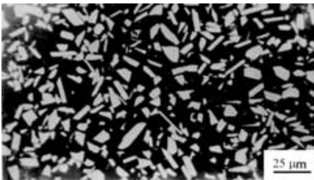
Figura 1. Fotografía obtenida mediante MOLR del material de Al_2O_3/30\%SiC_{pi} . Sección \perp al eje de prensado.
