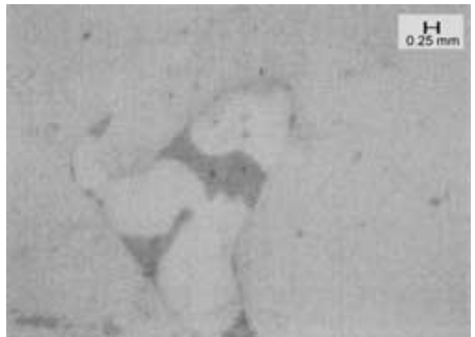
Figura 7.- Aspecto microscópico de las inclusiones de Si y Ti en el disperso de los refractarios R1(0) y R1(15)
