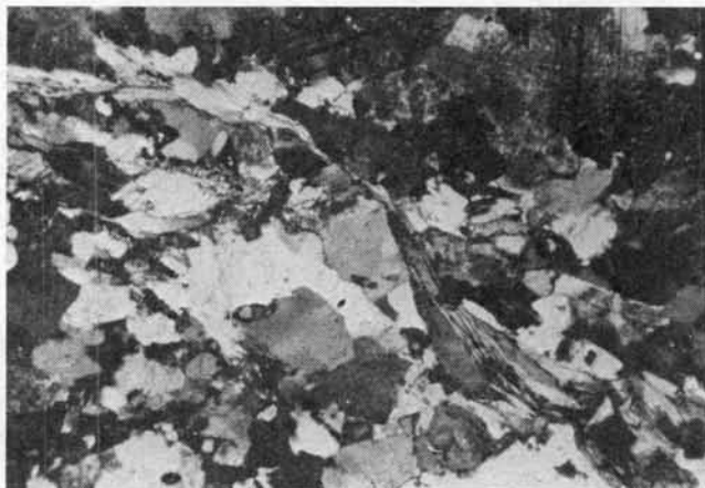
FIG. 115.—Roca madre del caolín de Vegas de Matute (granito orientado). Px.A., 3.2x8.
